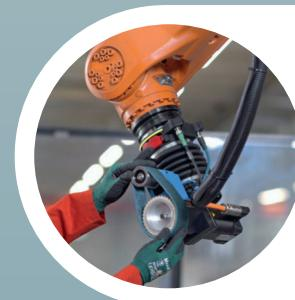
**SUHNER Robotic Grinding: Automatisierte Prozesse zur Oberflächenbearbeitung. Schruppen, Schleifen und Polieren.**
